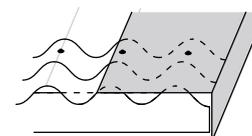
Il est aussi possible d'utiliser une bande ondulée, coupée dans un panneau ONDURA® Premium, et la placer sous la dernière ondulation sur l'inclinaison ou de fixer la dernière ondulation directement sur un bord de pente surélevé.
