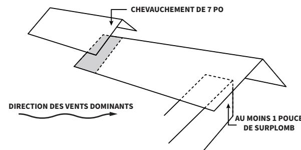
Insérer la bande de finition entre le panneau et le faîtage après que tous les panneaux ont été installés. Le centre de la bande de finition doit se trouver à 1 pouce au-dessus de l'extrémité la plus basse du faîtage. Fermer la zone située sous la crête à chaque extrémité à l'aide d'un faîtage.
