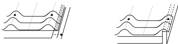
Une rive métallique peut également être utilisée, soit au-dessus, soit en dessous du bord de la dernière onde.
