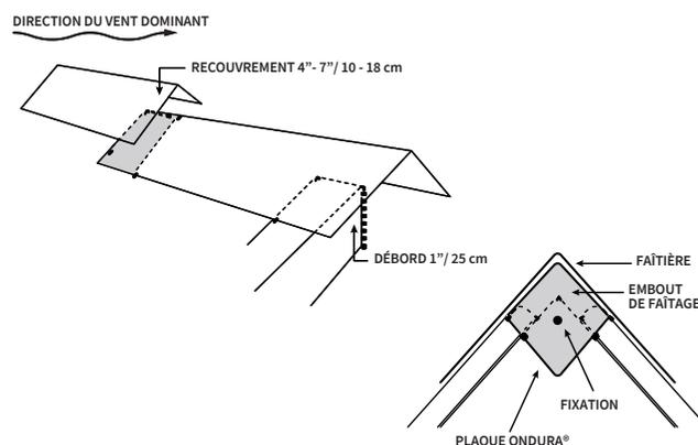
Avant de fixer les faîtières, positionnez la deuxième partie des cloisirs en mousse sur la plaque ONDURA®. Les faîtières viendront se positionner par-dessus la partie plane.
