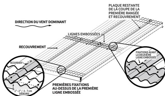
Chaque rangée doit idéalement être installée avec la première plaque installée à l'opposé des vents dominants, afin d'éviter un soulèvement de l'onde sous l'effet répété du vent. Si la pluie poussée par le vent peut venir des deux directions, nous recommandons de sceller le recouvrement avec un mastic élastomère.
